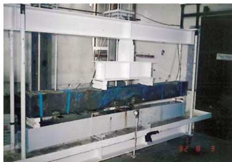
写真 11 はり供試体の持続荷重実験
