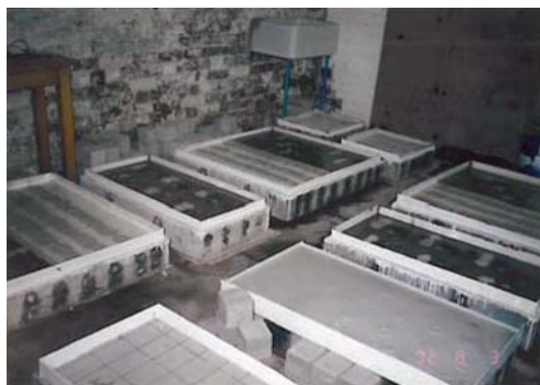
写真6 NaCl溶液の浸透実験
