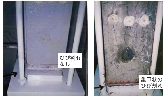
写真 12 柱供試体の実験荷重
