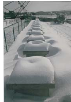
Non-AE コンクリート 空気量 1%
