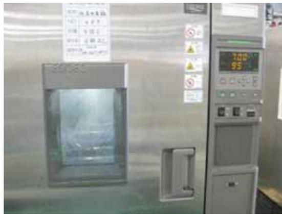
写真10 凍結・乾湿恒温槽
