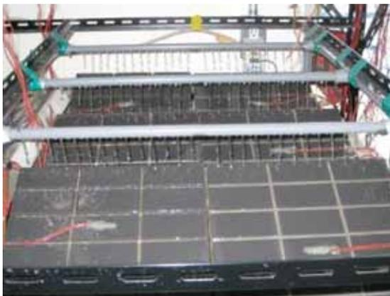
写真7 乾湿繰返し試験の散水状況
