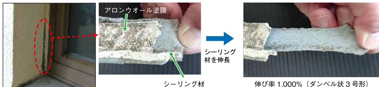
写真2 アロンウオールを施工後 25 年経過したシーリング材の状況
