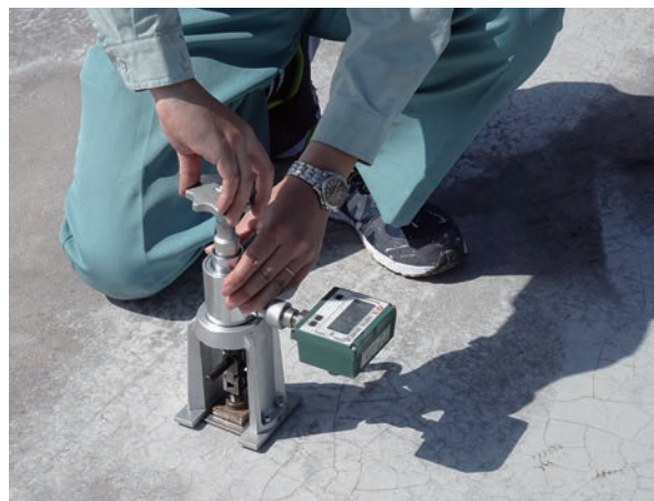
写真 3 付着強さ試験
